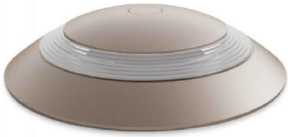
Segnapasso luminoso a LED CARIBONI tipo GRACE (o equivalente), 3000°K, 24V, IP67, IK10, Classe III, ottica asimmetrica diffondente 180°. Equipaggiato con cassaforma, driver di alimentazione e kit di giunzione a tre vie
