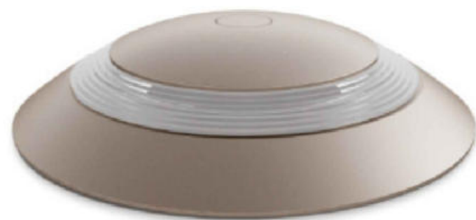
Segnapasso luminoso a LED CARIBONI tipo GRACE o equivalente), 3000°K, 24V, IP67, IK10, Classe III, ottica rotosimmetrica diffondente 360°. Equipaggiato con cassaforma, driver di alimentazione e kit di giunzione a tre vie
