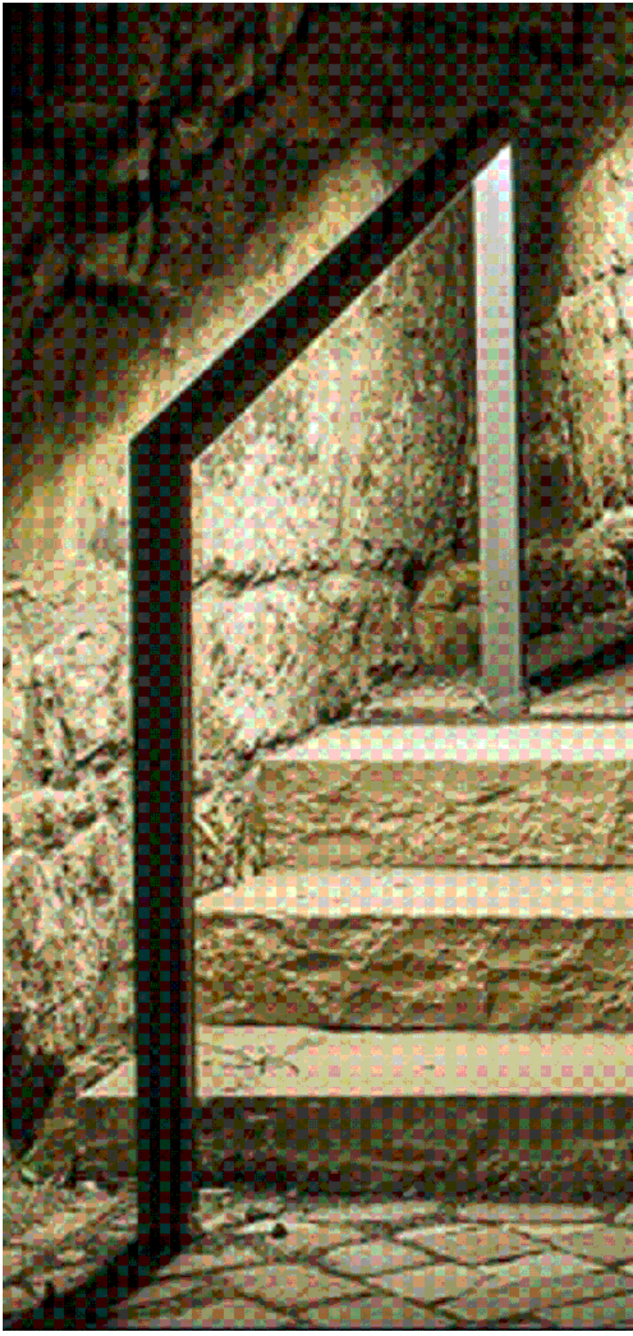
Corrimano in ferro tubolare completo di barra porta LED da incasso in alluminio, diffusore in policarbonato e striscia LED LINEALIGHT tipo PU_C PLUS (o equivalente) in silicone flessibile, 3000°K, 24V, IP67, Classe III Completo di driver di alimentazione da posizionarsi in cassetta stagna all'interno del pozzetto. Massima lunghezza di striscia alimentabile da ciascun driver 7,5m
